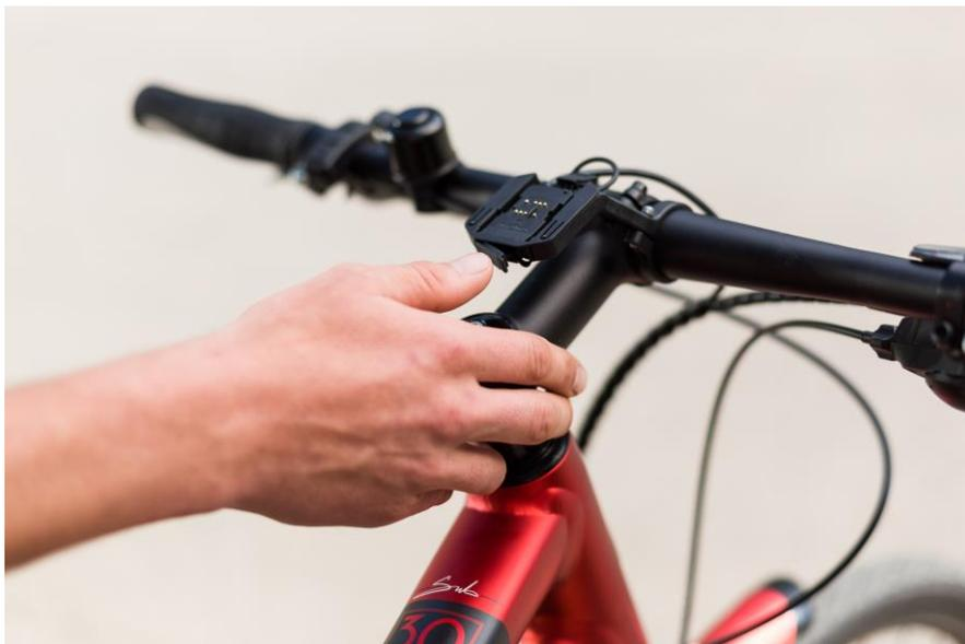
Abbildung 16 Gummiabdeckung der USB Schnittstelle der Displayhalterung schließen
