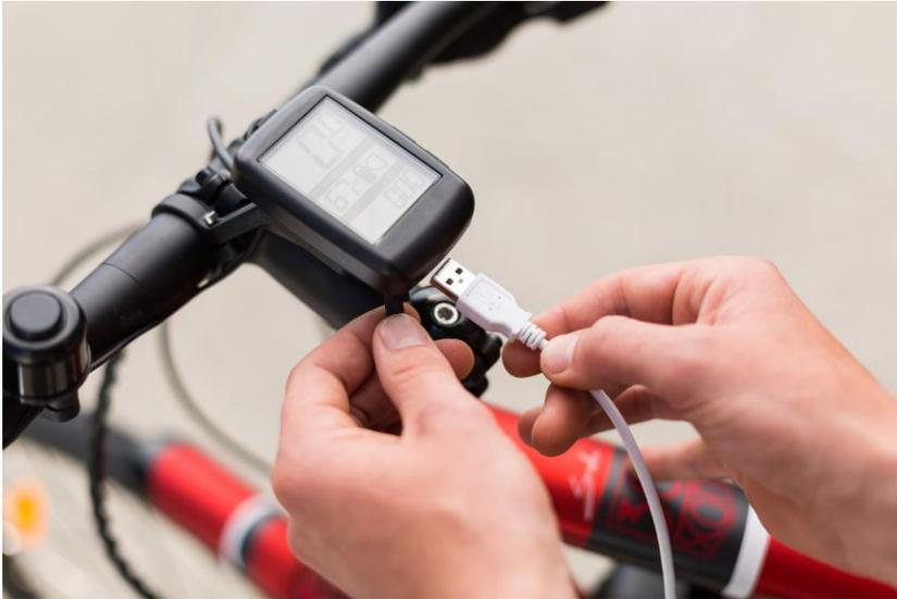
Abbildung 2 USB Kabel mit dem Display verbinden
