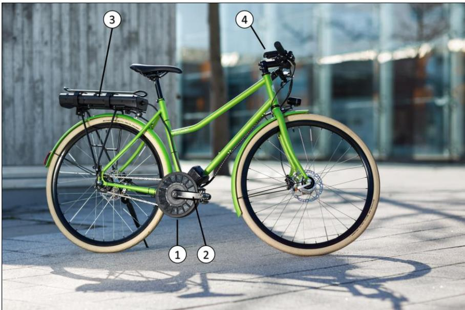
Abbildung 3: Position der Bauteile am EPAC mit Gepäckträgerakku:
