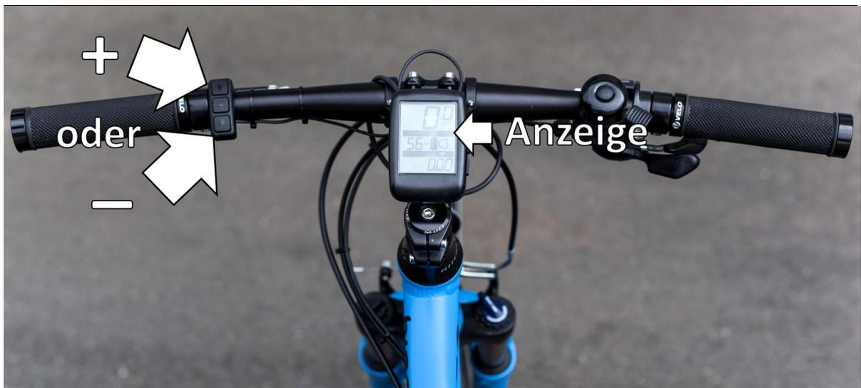
Abbildung 20: Wahl der Unterstützungsstufe
