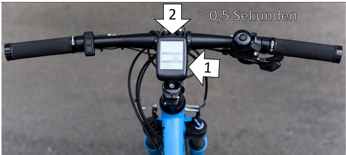
Abbildung 27: Umschalten zwischen km/h und mph
