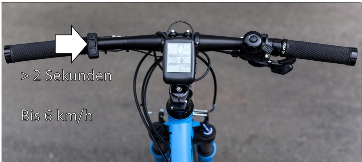
Abbildung 21: Schiebe- und Anfahrhilfe aktivieren
