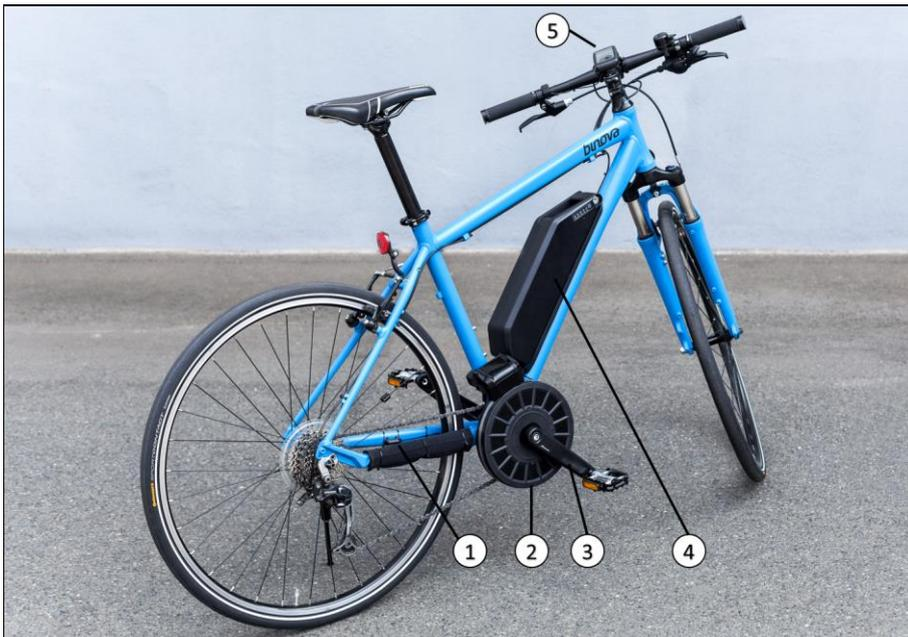
Abbildung 2: Position der Bauteile am EPAC mit Unterrohrakku:
